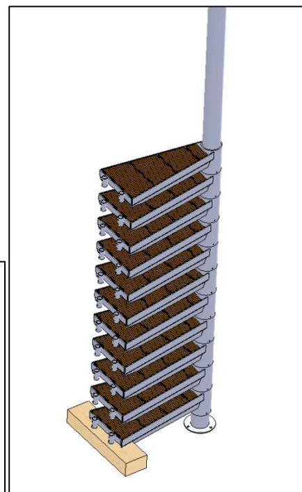
Déterminez le point de fixation de la colonne montante centrale et dressez la colonne sur ce point.
