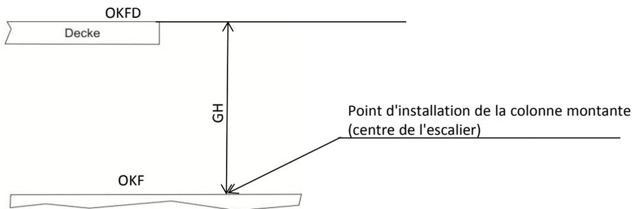
Mesurez la distance verticalement (**GH**) entre les surfaces finies (**OKF**) des deux niveaux d'étage (**OKFD**) » (voir figure 1).
