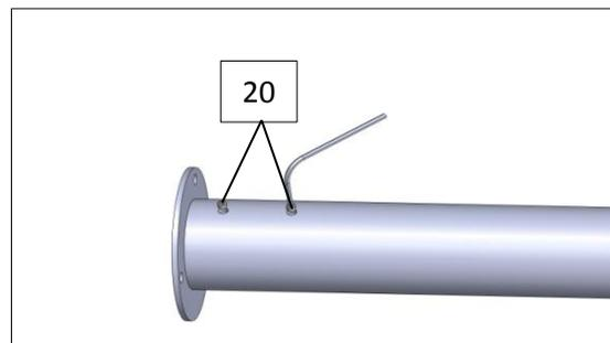
Placez le socle de fixation (1) dans la colonne montante centrale (2) et vissez les deux composants avec les vis sans tête (20).
