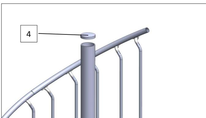
Enfoncez maintenant le tube d'extrémité sur la colonne montante centrale et fixez le tube au moyen des vis sans tête (20). Posez le capuchon (4) sur le tube d'extrémité.
