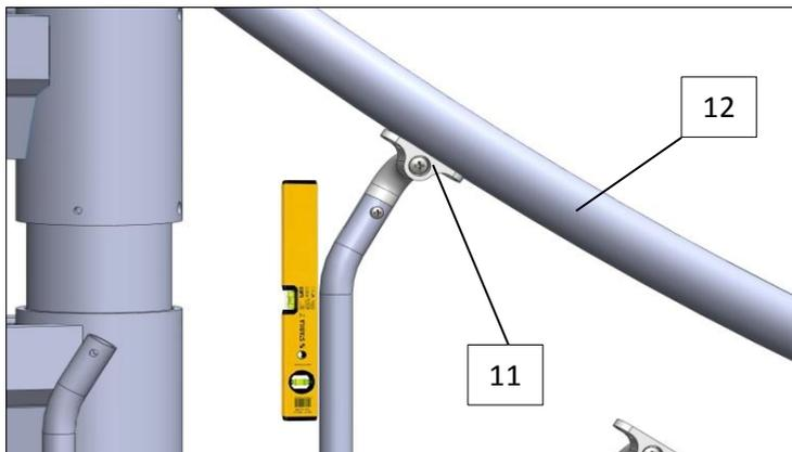
Après avoir posé les tronçons de tube sur les barres arrière, alignez les barres verticalement et fixez le support de la main courante (11) au tube de la main courante (12) au moyen de la vis à tête fraisée (19). Servez-vous du foret hélicoïdal (27) de 4 mm pour le préforage.
