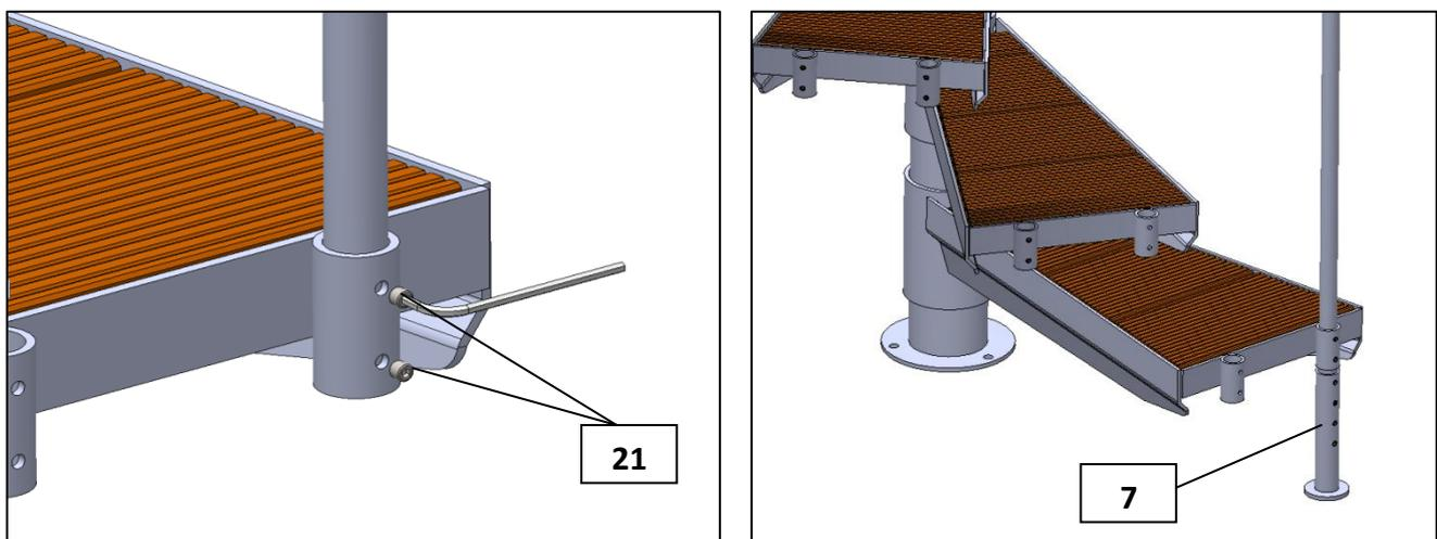
Après avoir inséré les barres longues, posez les barres courtes dans les supports de la main courante et laissez-les dépasser d'environ 15 cm vers le bas.
