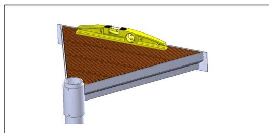
Alignez le palier d'arrivée avec le bord supérieur du plancher et vissez. Pour les planchers en bois, utilisez des tire-fonds de 8 x 50 mm. Pour les dalles en béton, ancrez le palier avec des chevilles pour charges lourdes
