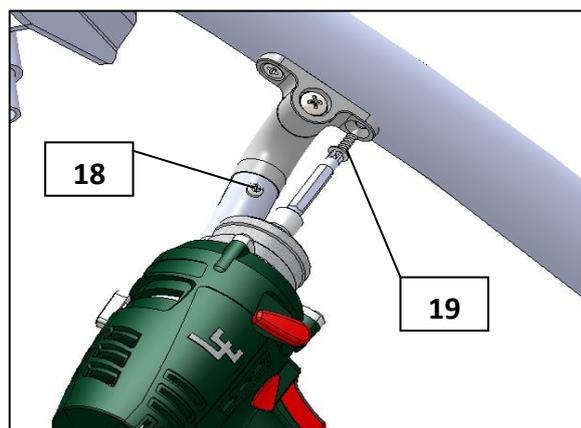
Procédez ensuite de la même façon avec les barres courtes. Après avoir entièrement vissé la main courante, il faut fixer les tronçons de tube aux points de passage avec les raccords. Percez avec le foret hélicoïdal de 4 mm les deux côtés du poteau (percez suffisamment profondément) et vissez avec la vis à tête cylindrique (18).
