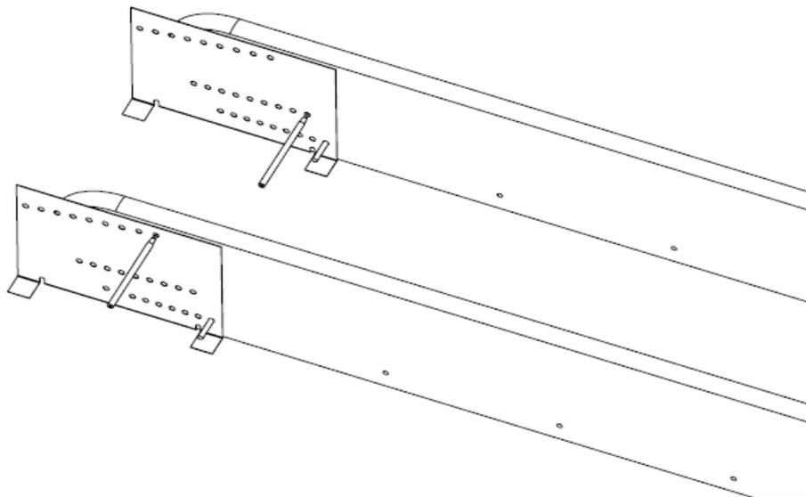
Après détermination de la hauteur de plafond, prendre la perçage fourni approprié et percer des trous (6mm) dans les parties latérales.
